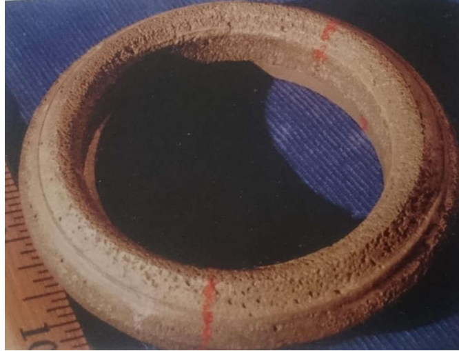
Slika 1.14. Rupičasta korozija aluminija 26
