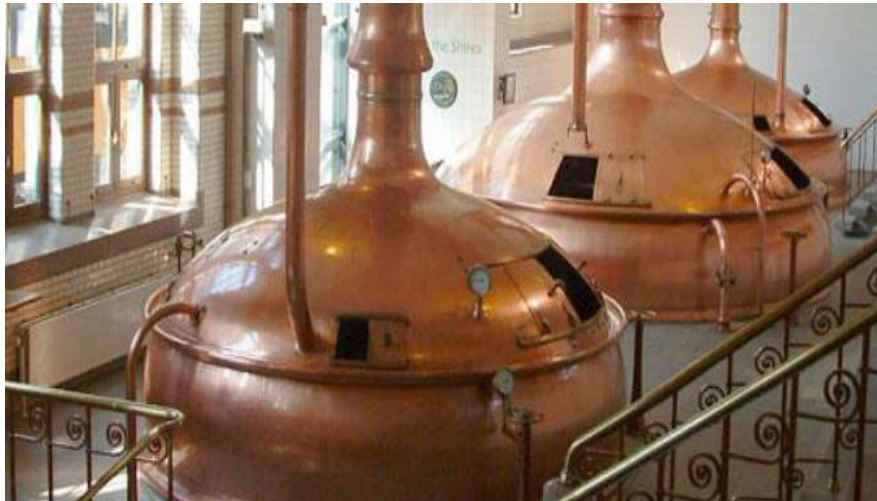
Slika 1.3. Kotlovi za kuhanje sladovine 14
