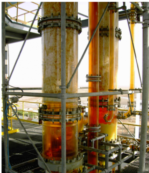
Slika 1.21. Izgled skrubera (engl. bromine scrubber ) 23
