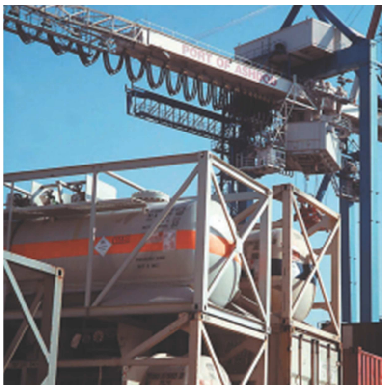
Slika 1.17. Tank za prijevoz tekućeg broma 20
