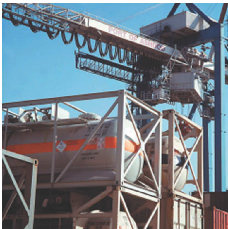
Slika 1.17. Tank za prijevoz tekućeg broma 20
