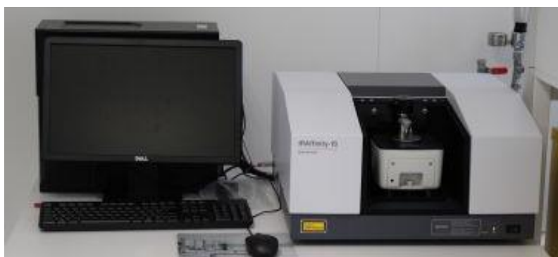
Slika 21. Preša za pravljenje pastila i uređaj za FT-IR analizu.
