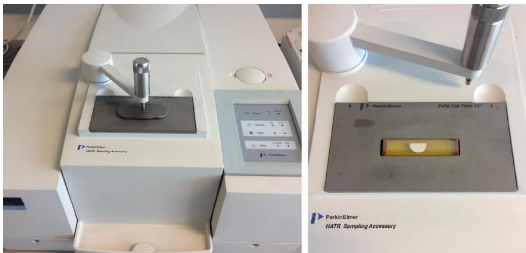
Slika 18. FT-IR spektrometar, Perkin-Elmer Spectrum One
