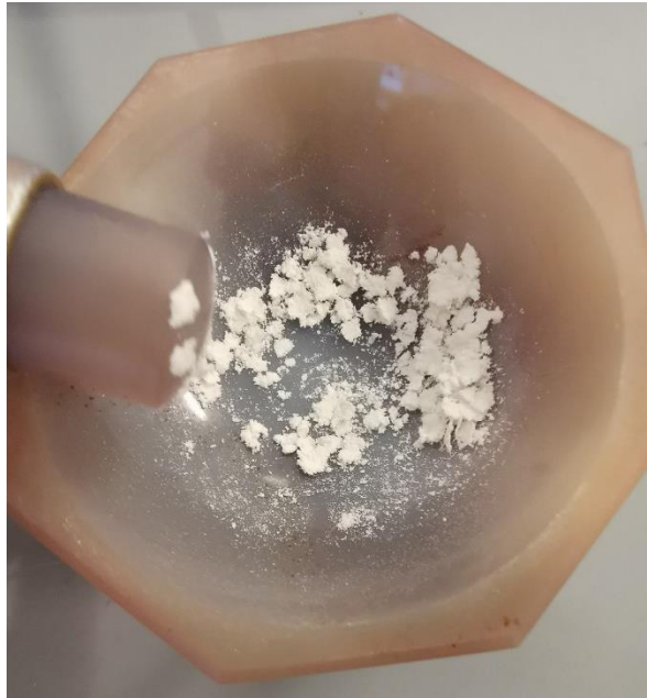
Slika 10. Homogenizacija uzorka miješanjem
