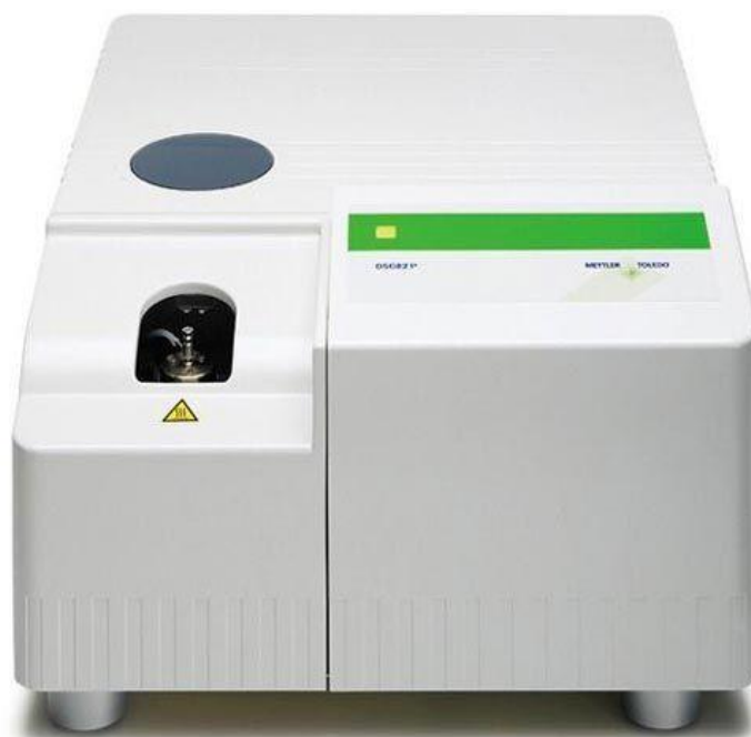
Slika 13. Uređaj za DSC (Mettler Toledo 823 e ) 23
