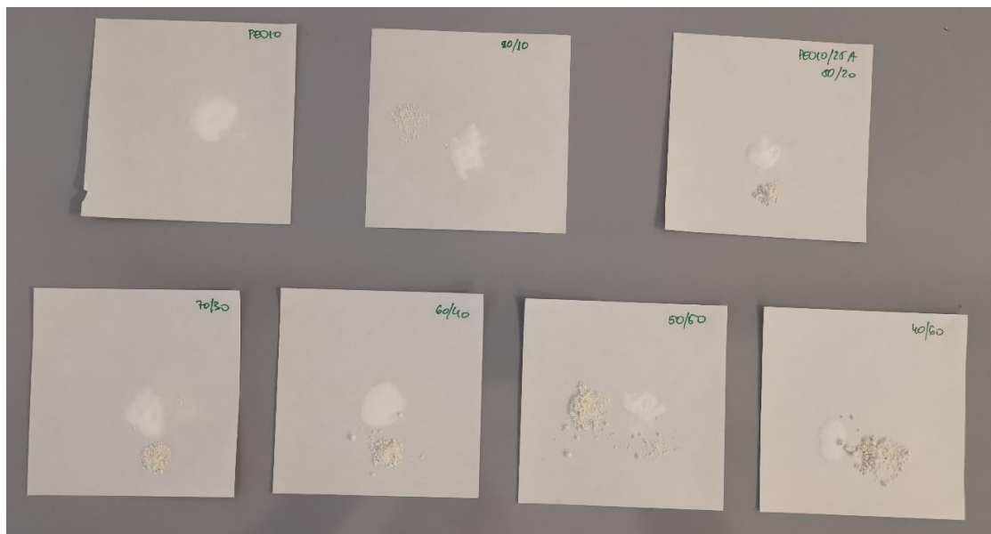
Slika 8. Izvagani uzorci različitog masenog udjela punila
