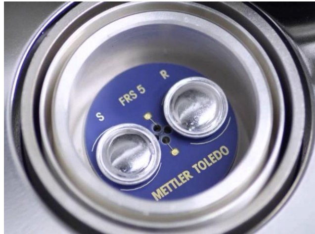
Slika 14. Mjerno osjetilo (FRS 5) DSC uređaja Mettler Toledo 823 e 24
