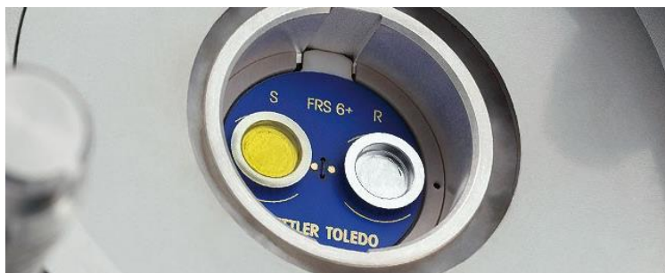
Slika 8. Čelije s referentnim i ispitivanim uzorkom 25
