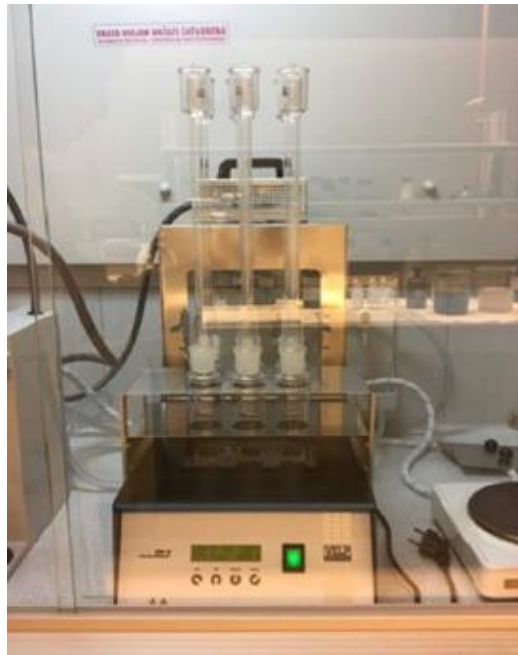
Slika 17. Kuhanje smjese u digestoru uz refluks
