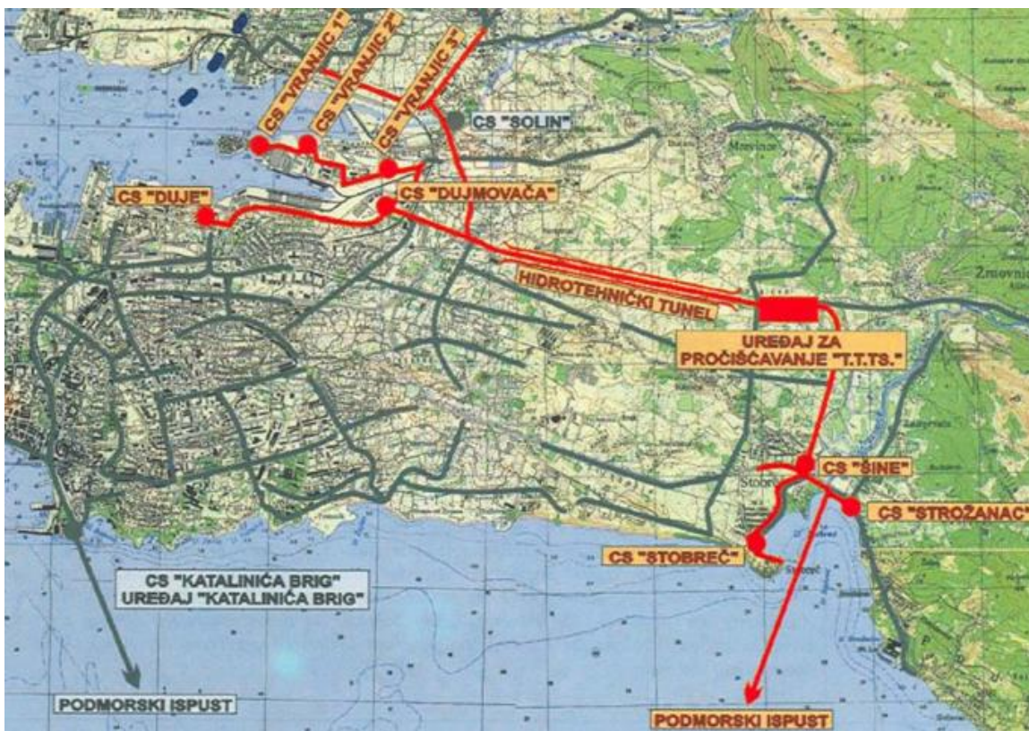
Slika 2. Prikaz koncepta izgradnje Kanalizacijskog sustava Split – Solin [9]
