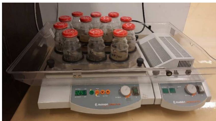
Slika 2.4. Laboratorijska tresilica „HeidolphUnimax 1010“ s uzorcima
