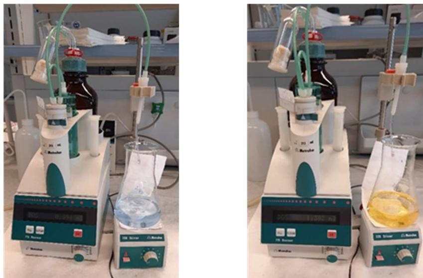
Slika 2.2. Prijelaz boje pri kompleksometrijskom određivanju olova na automatskom titratoru „Metrohm 775 Dosimat“
