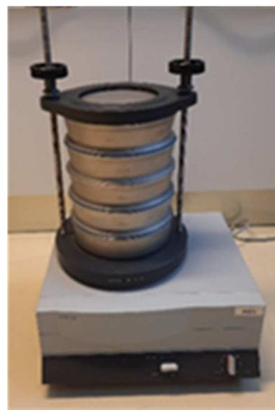
Slika 2.3. Uređaj za prosijavanje „Retsch AS 200 bacić“
