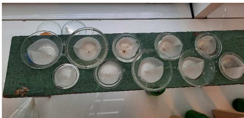
Slika 2.5. Filtriranje suspenzija nakon sorpcije
