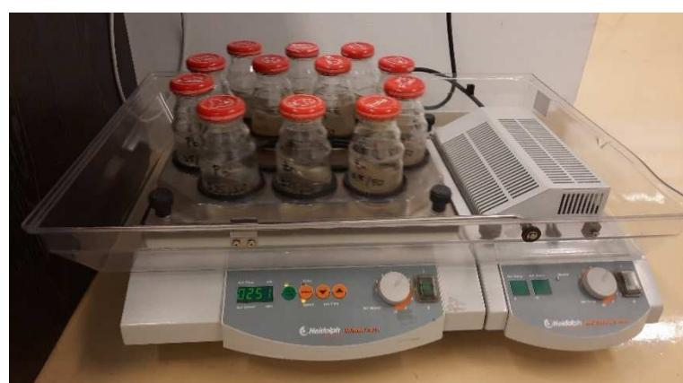
Slika 2.4. Laboratorijska tresilica „HeidolphUnimax 1010“ s uzorcima
