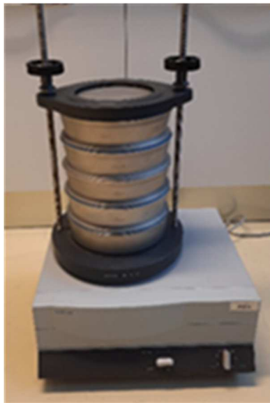
Slika 2.3. Uređaj za prosijavanje „Retsch AS 200 basic“
