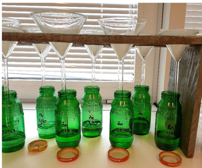
Slika 2.8. Filtriranje suspenzija nakon sorpcije u trajanju od 24 h
