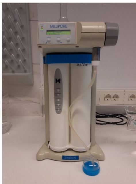
Slika 2.2. Uređaj „Millipore“ za pripremu ultračiste vode
