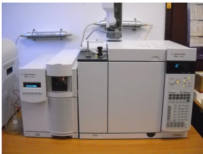
Slika 16. Vezani sustav plinska kromatografija-spektrometrija masa (GC-MS) (Izvor: autor)
