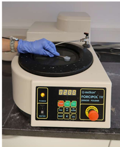
Slika 2.2. Priprema radne površine AISI 304L, AISI 3016L i 2205 DSS na uređaju Metkon Forcipol 1V.
