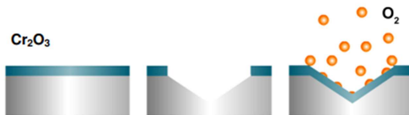
Slika 1.13. Prikaz mehanizma repasivacije (samoobnavljanja) pasivnog filma kromovog oksida na površini materijala. 25
