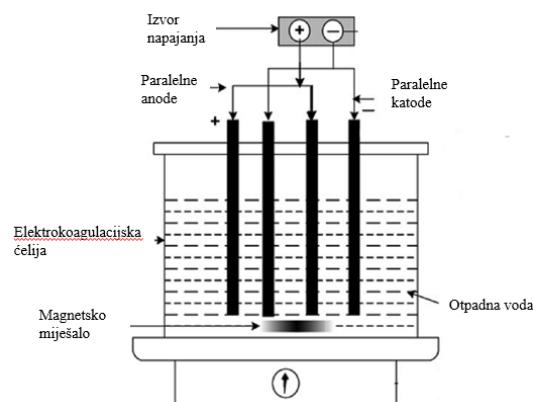
Slika 7. Proces EC u šaržnom reaktoru<sup>36</sup>
