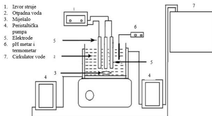
Slika 8. Proces EC u kontinuiranom reaktoru<sup>35</sup>
