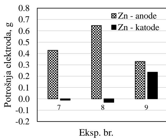
**Slika 24.** Grafički prikaz potrošne Zn elektroda
