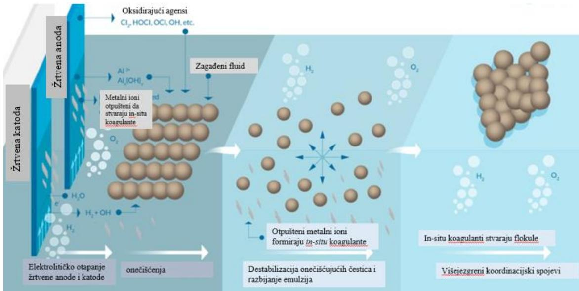
**Slika 5.** Mehanizam procesa elektrokoagulacije<sup>29</sup>
