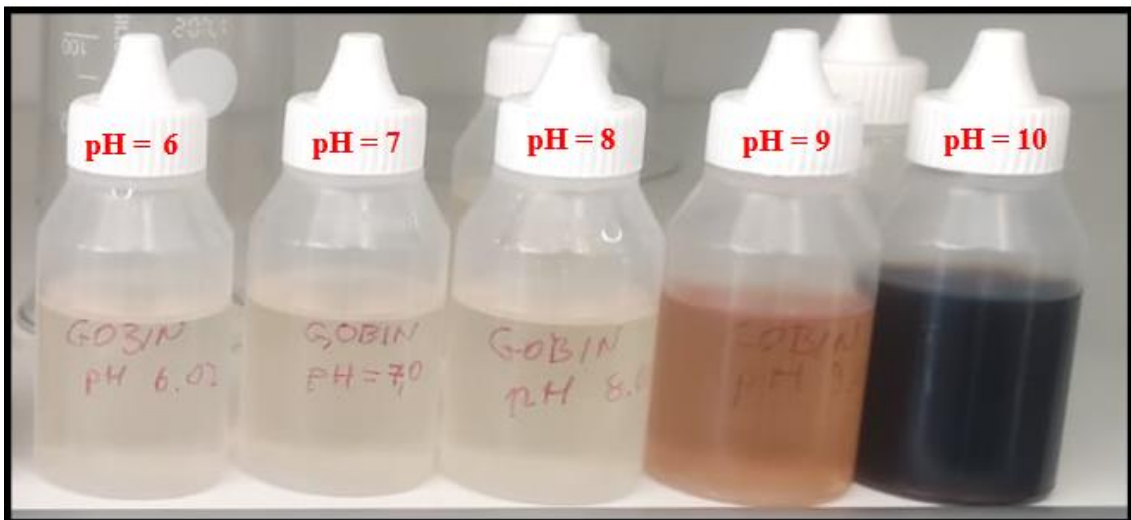
Slika 14. Koloidi srebra sintetizirani pri različitim pH vrijednostima
