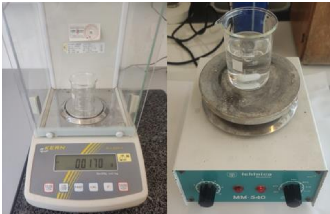
Slika 11. Priprava otopine srebrova nitrata određene koncentracije
