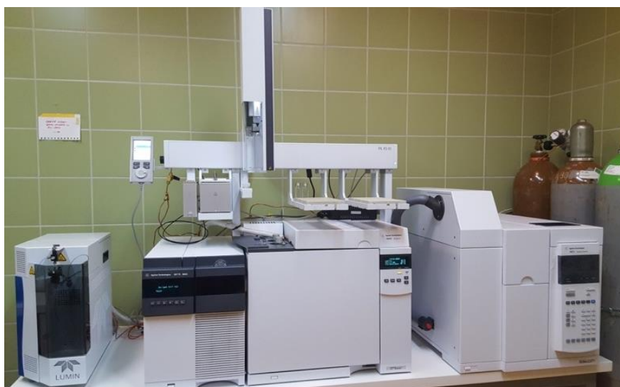
Slika 20. Spregnuta tehnika plinska kromatografija-spektrometrija masa (GC-MS) (35)
