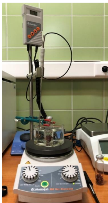
Slika 19. Aparatura za mikroekstrakciju vršnih para na krutoj fazi (HS-SPME)
