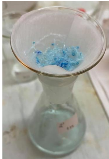
Slika 16. Filtracija i ispiranja regeneriranih celuloznih vlakana
