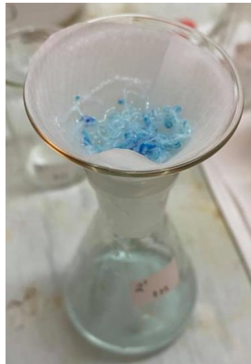
Slika 16. Filtracija i ispiranja regeneriranih celuloznih vlakana
