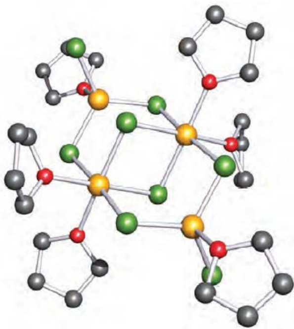
Slika 8. Kompleks [\text{Co}_4\text{Cl}_2(\mu\text{-Cl})_6(\text{THF})_6] (atomi vodika su izostavljeni, a atomi kobalta su prikazani žutom, klora zelenom, ugljika sivom, a kisika crvenom bojom) [6].
