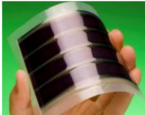
Slika 19. Tankoslojna ćelija na osnovi nanokristaličnog \text{TiO}_2 28
