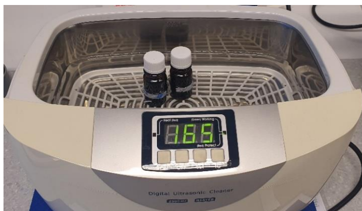
Slika 33. Ultrazvučna kupelj s uzorcima elektrolita
