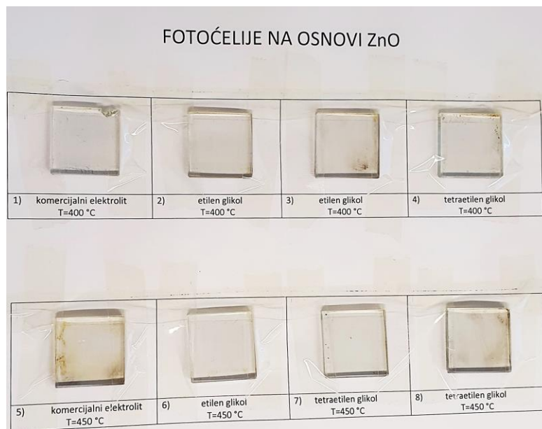
Slika 38. Stakalca zalijepljena ljepljivom trakom
