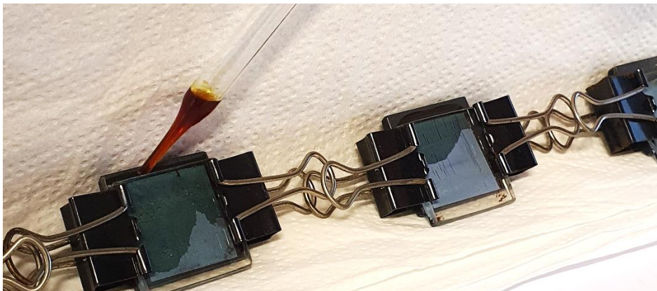
Slika 48. Dodavanje elektrolita u sloj ZnO između spojenih stakalaca
