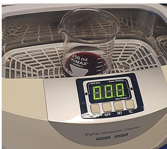
Slika 30. Potpomognuta ekstrakcija antocijanina u ultrazvučnoj kupelji
