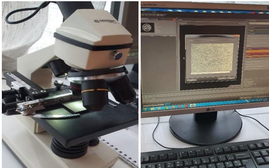
Slika 51. Digitalni mikroskop korišten za snimanje površine slojeva solarne ćelije
