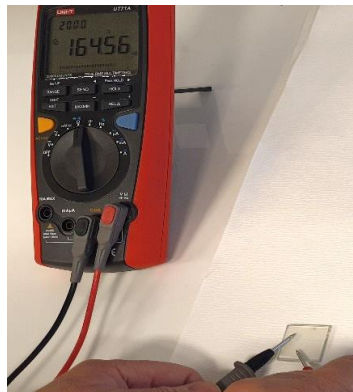
Slika 36. Određivanje vodljive strane stakalca pomoću multimetra
