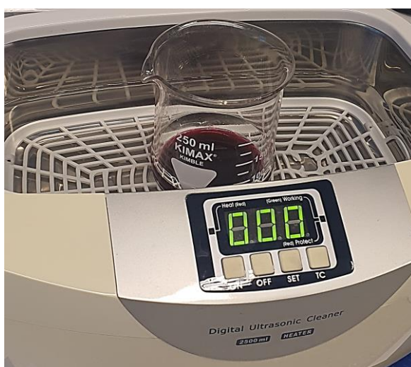
Slika 30. Potpomognuta ekstrakcija antocijanina u ultrazvučnoj kupelji
