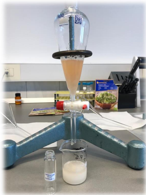
Slika 2.11. Ekstrakcija hlapljivih razgradnih produkata glukozinolata diklormetanom.
