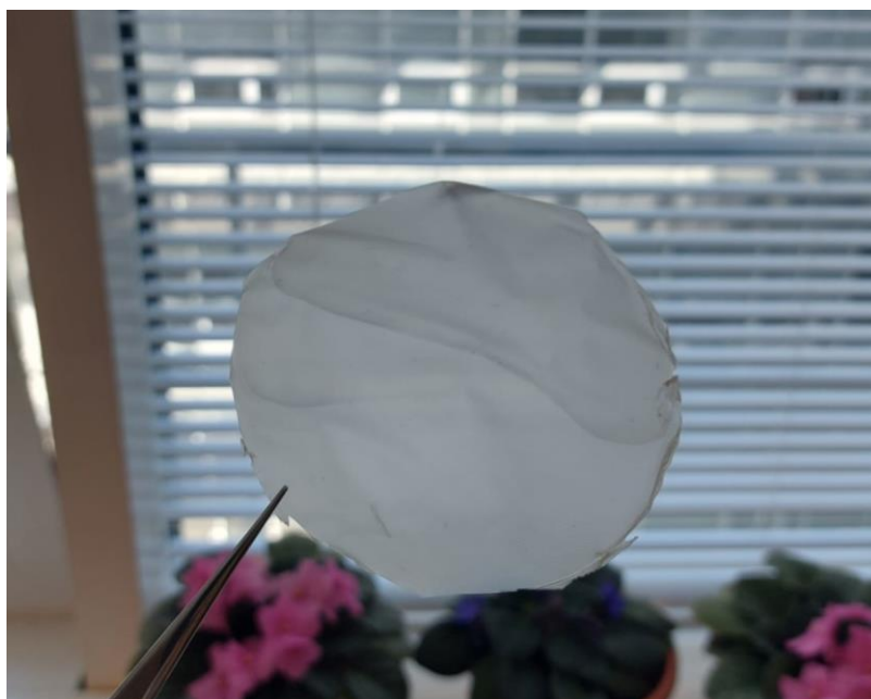
Slika 12. Film mješavine PHB/SME 85/15
