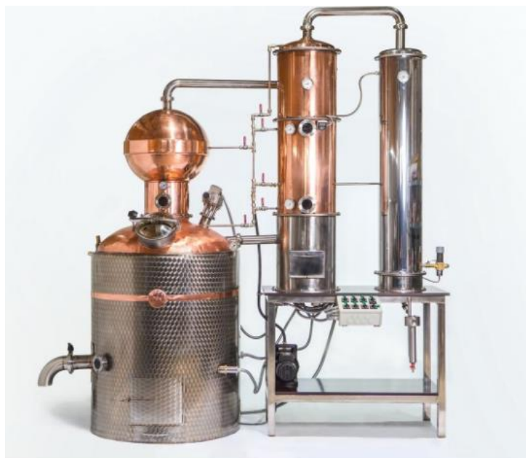
Slika 5. Uređaj za destilaciju s rektifikacijskom kolonom [20]
