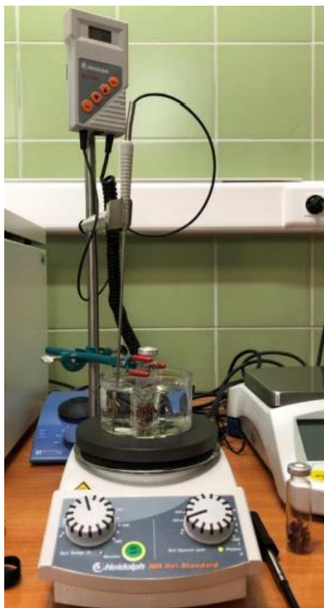
Slika 19. Aparatura za mikroekstrakciju vršnih para na krutoj fazi (HS-SPME)
