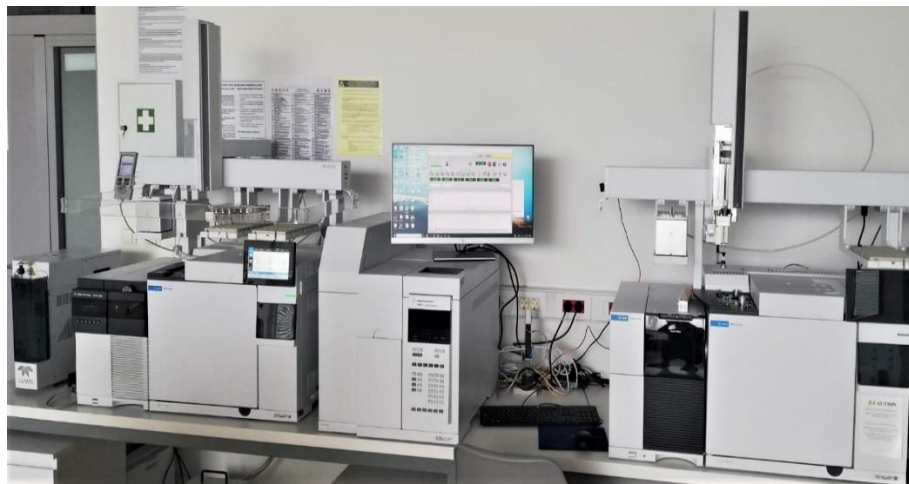
Slika 13. Vezani sustav plinska kromatografija-spektrometrija masa (GC-MS)
