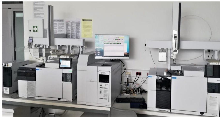
Slika 13. Vezani sustav plinska kromatografija-spektrometrija masa (GC-MS)
