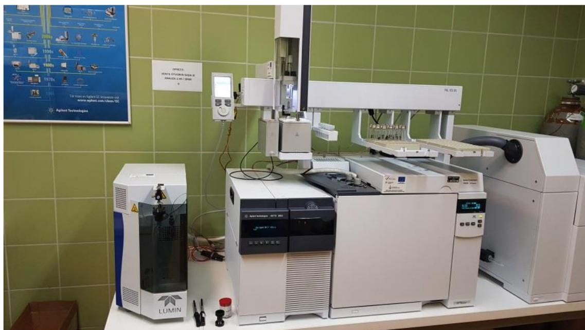
**Slika 16.** Vezani sustav plinska kromatografija-spektrometrija masa (GC-MS)
