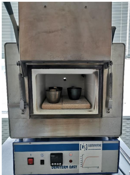
Slika 2.12. Određivanje udjela pepela u pripremljenim uzorcima biougljena
