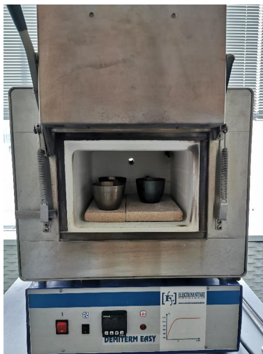
Slika 2.12. Određivanje udjela pepela u pripremljenim uzorcima biougljena
