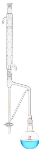
Slika 34. Aparatura po Clevengeru (71)
