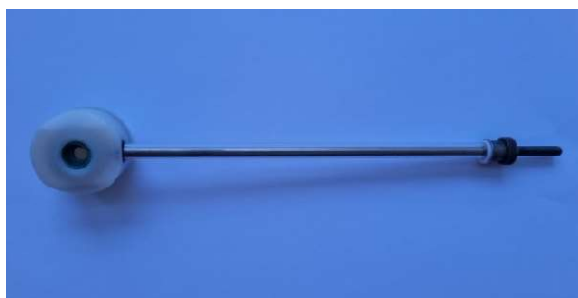
Slika 2.2. Radna elektroda- legura \text{Ni}_{57}\text{Co}_{43} u držaču.
