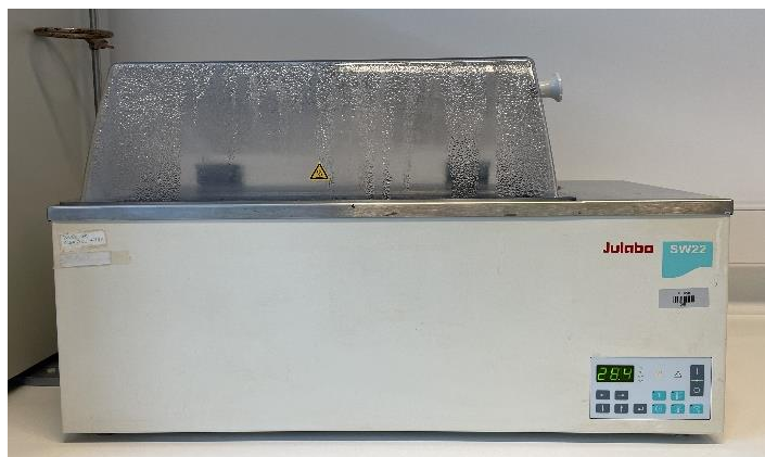
Slika 13. Uređaj za trešnju s vodenom kupelji JULABO SW22
