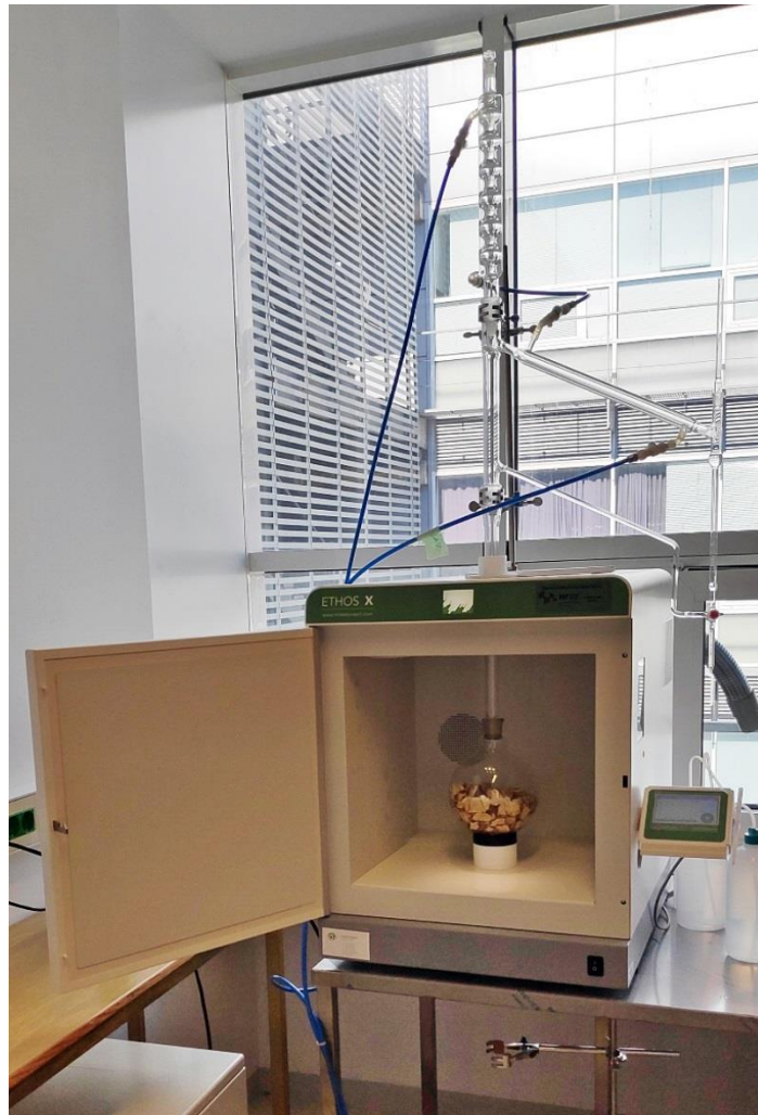
Slika 3.3.2.1.1. Uređaj za mikrovalnu destilaciju.
