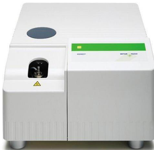
Slika 12. Diferencijalni pretražni kalorimetar Mettler Toledo 823 e
