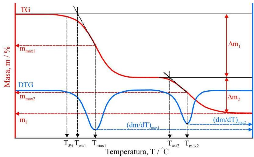
Slika 13. Određivanje značajki termogravimetrijskih krivulja<sup>22</sup>
