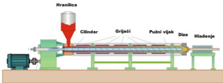
Slika 8. Shematski prikaz ekstrudera<sup>14</sup>
