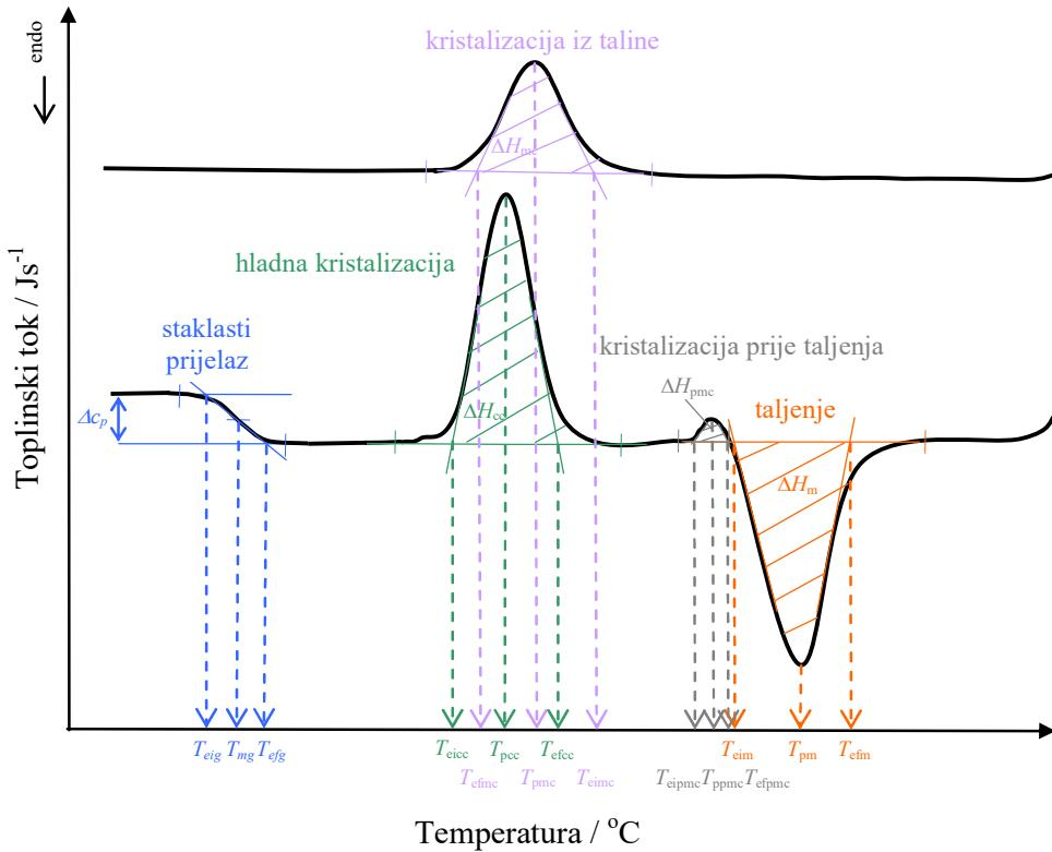
Slika 12. Određivanje značajki krivulje diferencijalne pretražne kalorimetrije<sup>22</sup>
