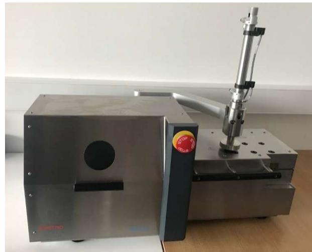
**Slika 11.** Dvopužni laboratorijski ekstruder HAAKE MiniLab 3
