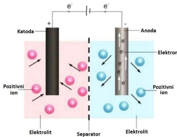
Slika 9. Shematski prikaz baterije<sup>16</sup>
