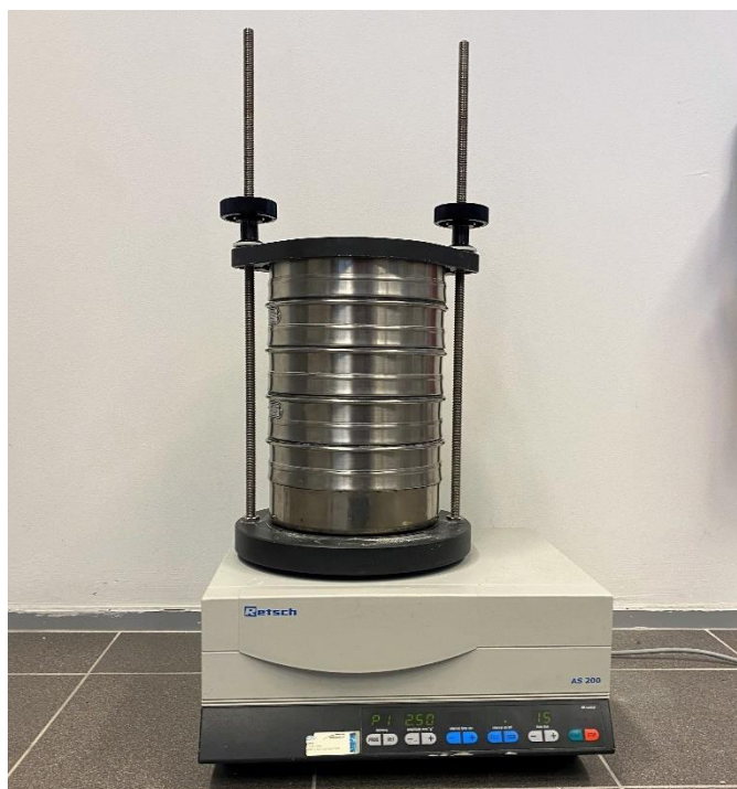
Slika 15. Aparatura za prosijavanje čestica.
