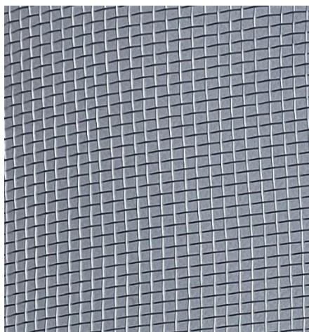
Slika 12. Mrežica – nosač poroznog sloja u koloni.
