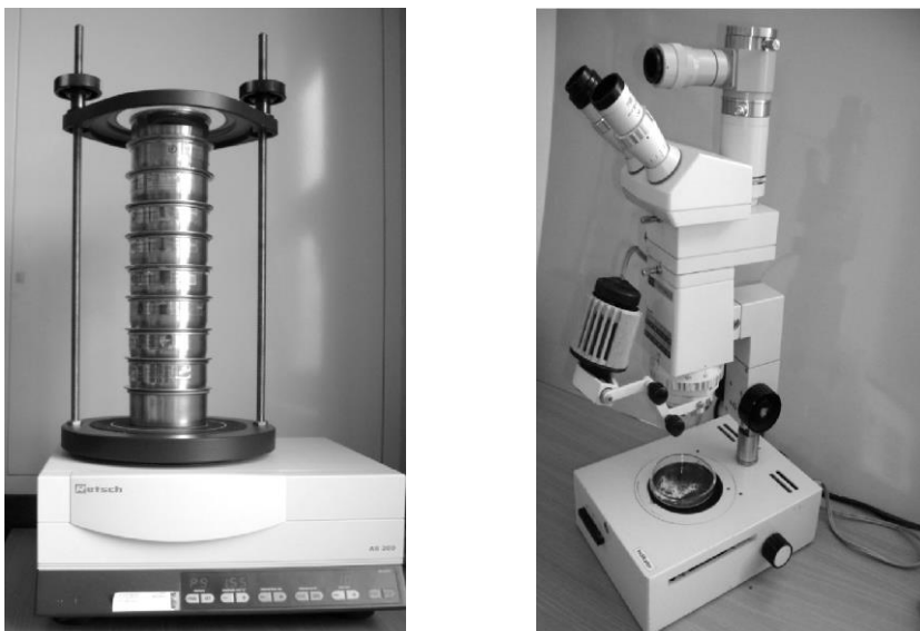
Slika 16. Mehanička tresilica tipa Retsch AS 200 (lijevo) i optička lupa Carl Zeiss Jena (desno).
