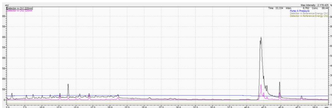
Slika 10. Primjer izgleda HPLC kromatograma testiranih uzoraka
