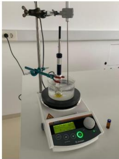
Slika 2.1 Aparatura za adsorpciju uzorka na sivo vlakno
