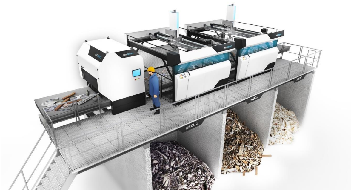
Slika 21. ZenRobotics postrojenje za sortiranje otpada 37
