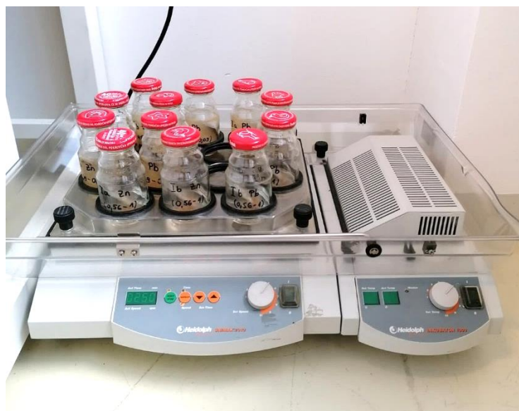
Slika 2.7. Laboratorijska tresilica Heidolph Unimax 1010 s uzorcima
