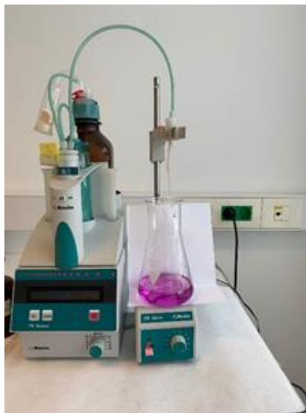
Slika 2.4. Promjena boje prilikom određivanja cinka kompleksometrijskom titracijom
