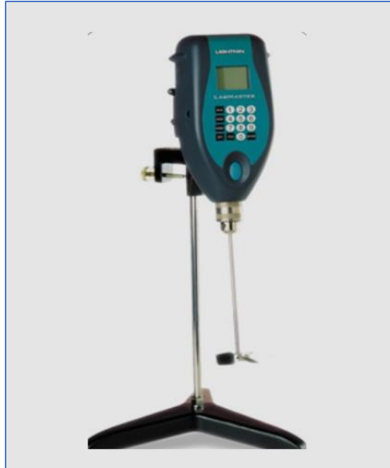
Slika 15. Miješalica tipa Lightning Labmaster LIU10F.
