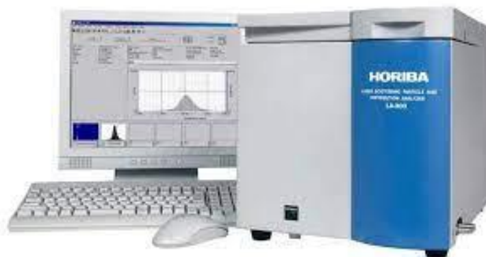
Slika 19. Uređaj za lasersku difrakciju Horiba LA 300 .
