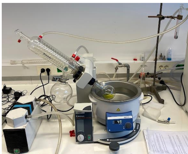
Slika 16. Uklanjanje etanola rotacionim vakuum uparivačem
