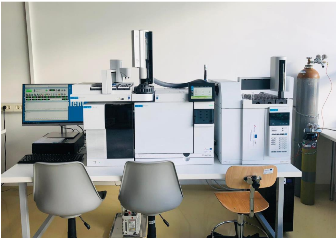
Slika 2.2. Plinski kromatograf sa spektrometrom masa s trostrukim kvadrupolom i automatskim uzorkivačem 8890 GC-7000D GC/TQ (Agilent Technologies, SAD)
