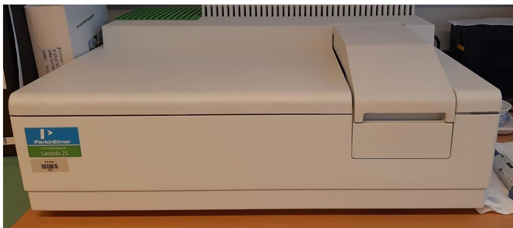
Slika 17. UV/VIS spektrofotometar Perkin Elmer Lambda 25
