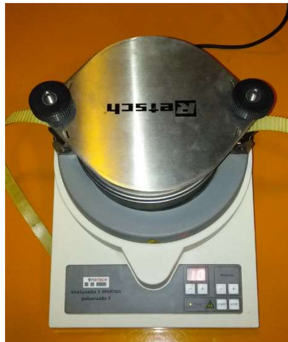
Slika 10. Fritsch analysette 3 Spartan pulverisette 0 treskalicu sa sitima veličine očića većih 250 \mu\text{m} , 125 \mu\text{m} i 45 \mu\text{m}
