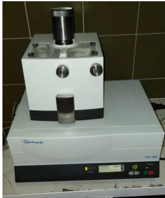
Slika 9. Retsch RM 200 mlin
