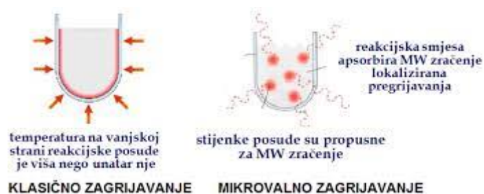
Slika 15. Usporedba klasičnog i mikrovalnog zagrijavanja 25
