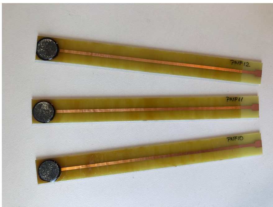
Slika 17. Prikaz ionsko selektivnih elektroda laboratorijske izrade
