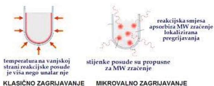
Slika 15. Usporedba klasičnog i mikrovalnog zagrijavanja 25
