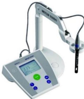
*Slika 2.4 Konduktometar tipa Mettler Toledo*
