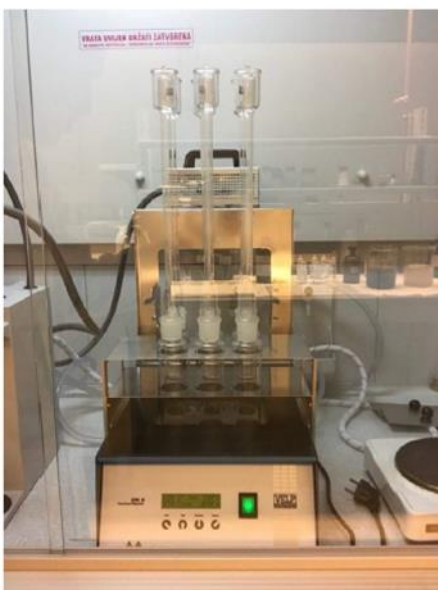
Slika 2.5 Kuhanje smjese u digestoru
