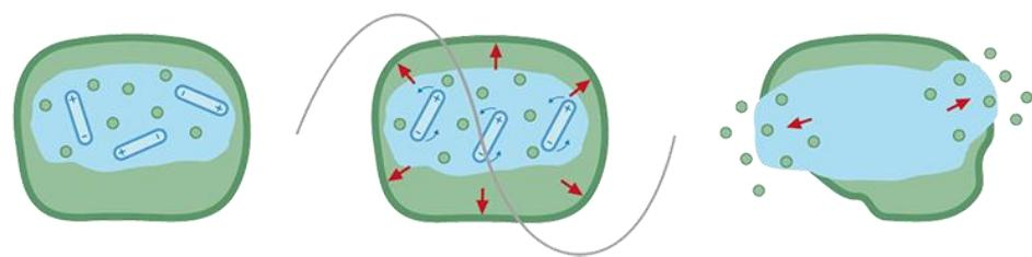
Slika 6. Mechanizam mikrovalnog zagrijavanja<sup>37</sup>
