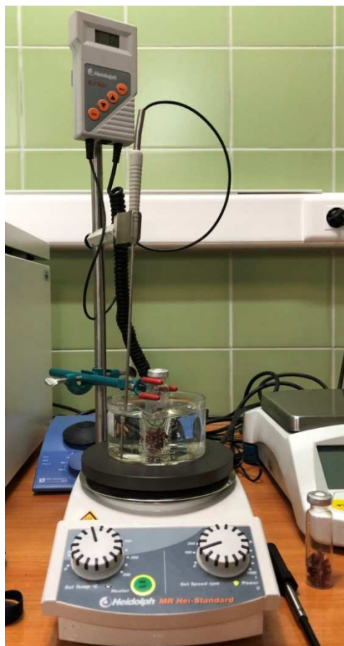
Slika 10. Aparatura za mikroekstrakciju vršnih para na krutoj fazi (HS-SPME)
