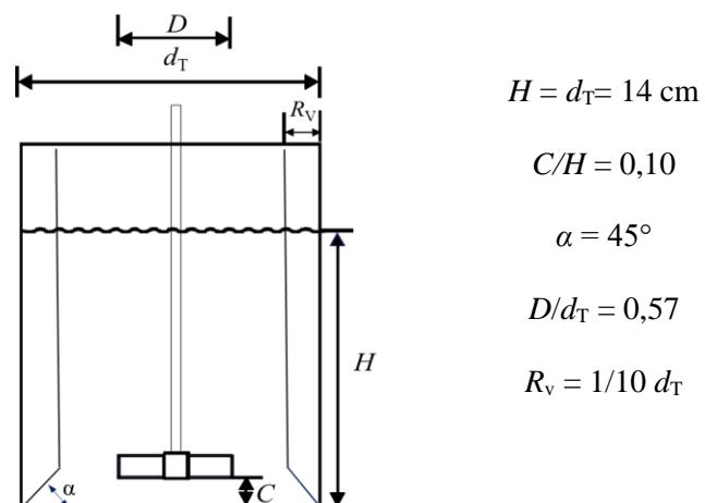
Slika 20. Shematski prikaz i osnovne karakteristike kotlastog reaktora sa SBT mijesalom
