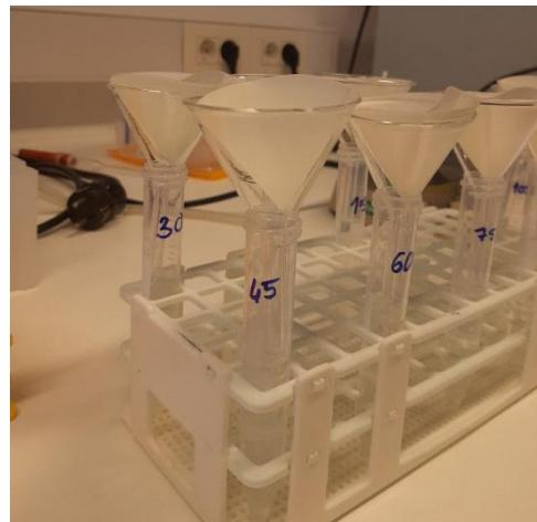
**Slika 26.** Filtriranje uzoraka nakon centrifuge
