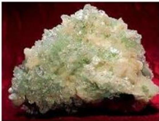
Slika 9. Prirodni zeolit klinoptilolit 21
