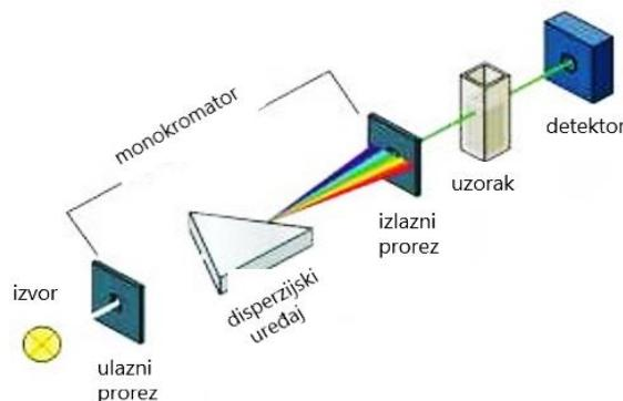
**Slika 25.** Princip rada spektrofotometra<sup>54</sup>
