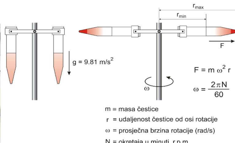
**Slika 23.** Princip centrifugiranja<sup>53</sup>
