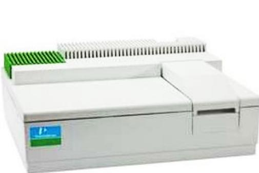
**Slika 24.** Spektrofotometar Perkin Elmer Lambda 25 UV/VIS<sup>54</sup>
