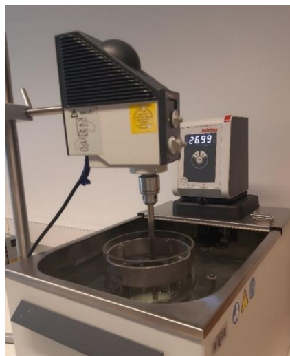
Slika 19. Kotlasti reaktor uronjen u termostatiranu kupelj
