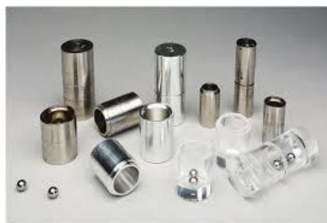
**Slika 4.** Prikaz reakcijskih posudica od čelika, aluminija i PMMA te čeličnih kuglica.<sup>[37]</sup>
