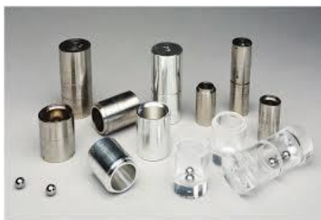
Slika 4. Prikaz reakcijskih posudica od čelika, aluminijskog i PMMA te čeličnih kuglica. [37]
