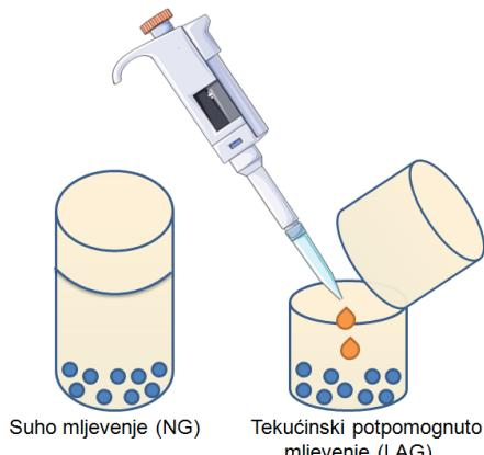
**Slika 2.** Shematski prikaz suhog (NG) i tekućinski potpomognutog mljevenja (LAG).<sup>[22]</sup>
