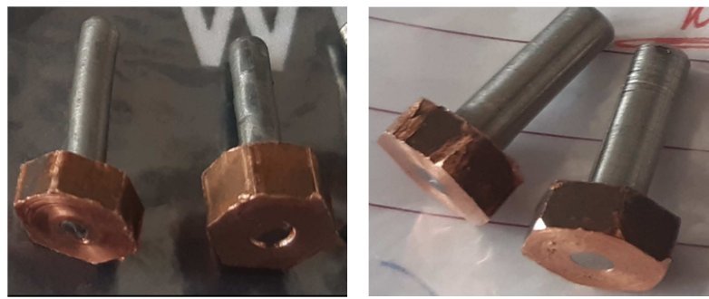
Slika 2.2. Kontakt na uzorcima a) Ti i b) Ti-6V-4Al legure
