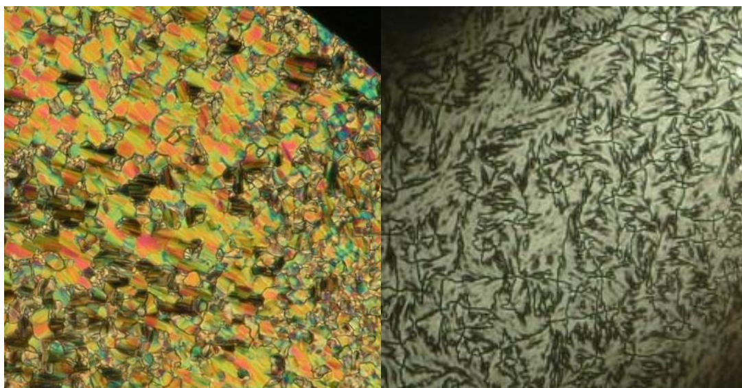
Slika 17 - Fotografije spoja 9 (povećanje 500), interkalacijska smektička faza: a) lepezasta tekstura, b) Schlieren tekstura dobivena nakon smicanja uzorka
