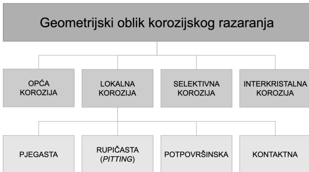
Slika 3. Klasifikacija korozije prema geometrijskom obliku koroziskog razaranja.<sup>7</sup>
