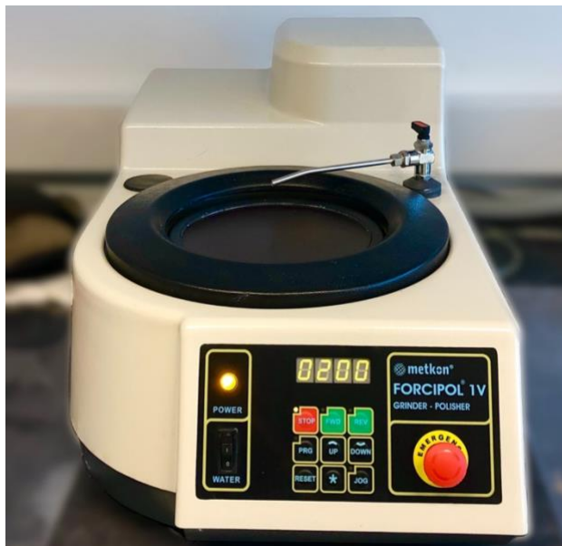
Slika 31. Uređaj za mehaničku obradu površine elektrode.
