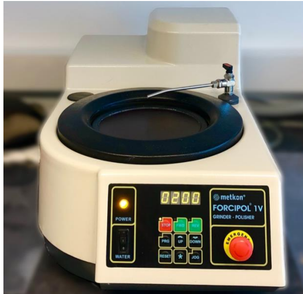
Slika 31. Uređaj za mehaničku obradu površine elektrode.
