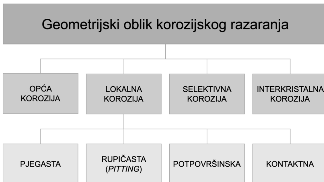
Slika 3. Klasifikacija korozije prema geometrijskom obliku korozijskog razaranja. 7
