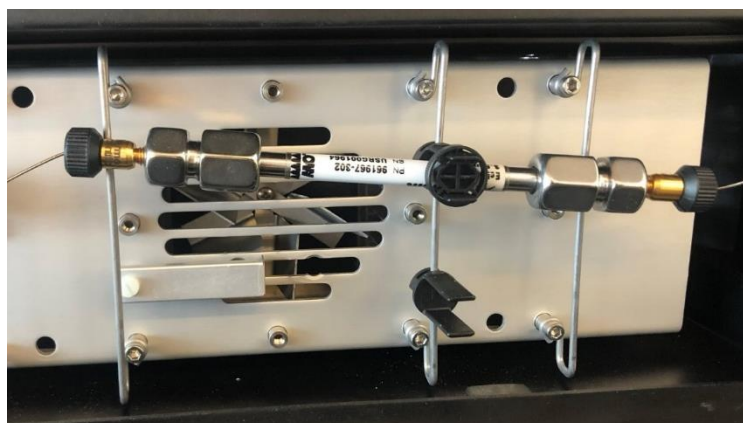
Slika 30. Stacionarna faza (Hypersil GOLD C-18 kolona)
