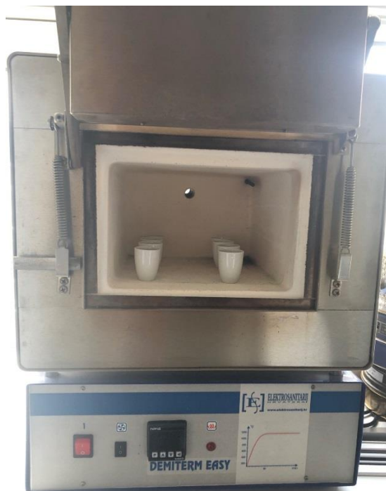
Slika 26. Uzorci na žarenju u peći
