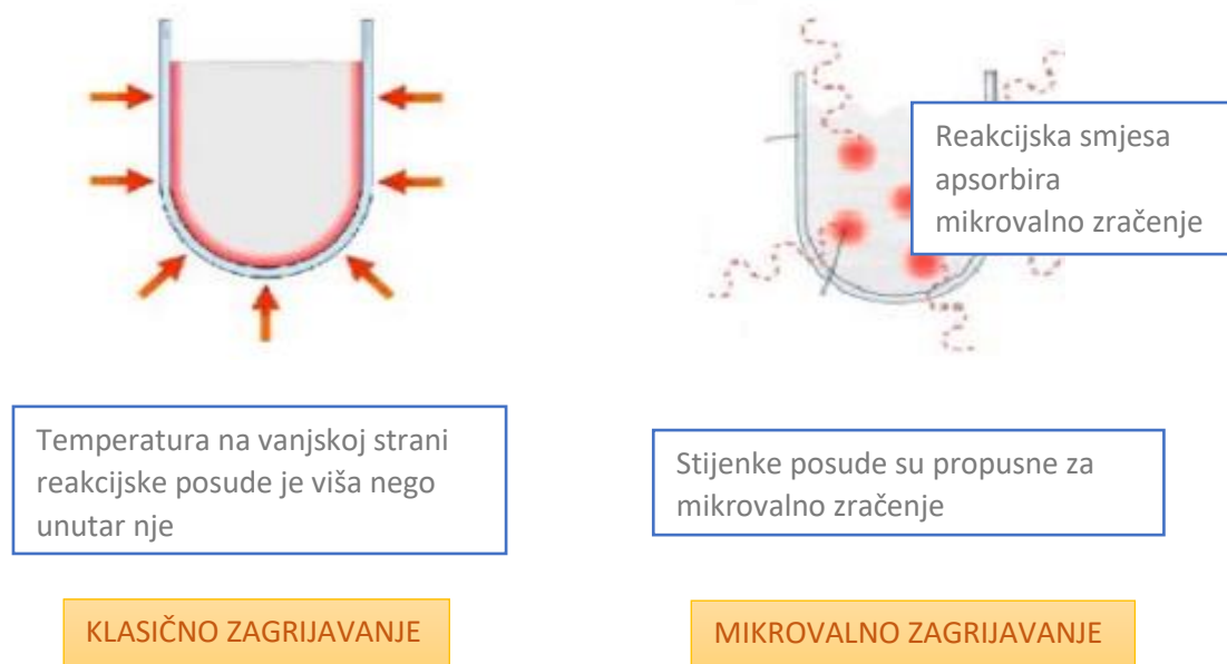
Slika 9. Usporedba klasičnog i mikrovalnog zagrijavanja 13
